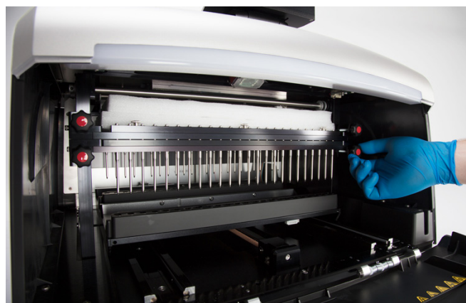
Rysunek 63. Umieszczanie ograniczników z tworzywa sztucznego. Podnieść pręt magnesu i pręt tłoczków do góry, a następnie zamocować cztery śruby transportowe po obu stronach pręta magnesu i pręta tłoczków.
