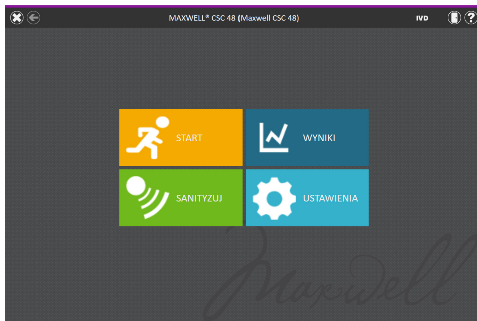
Rysunek 57. Ekran główny. Naciśnięcie przycisku Sanityzuj spowoduje uruchomienie procedury sanityzacji aparatu Maxwell® CSC 48 Instrument z wykorzystaniem promieniowania UV.
