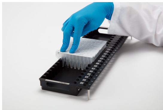
Rysunek 40. Umieścić kasety na tacy blatowej, a następnie mocno nacisnąć, aby odpowiednio się zatrzaskowały.
