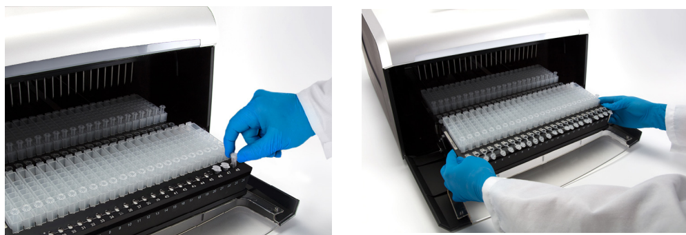
Rysunek 46. Wyjmowanie rurek do elucji i tac białkowych.
