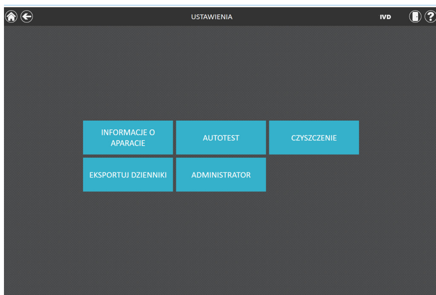
Rysunek 16. Ekran „Ustawienia” oprogramowania Maxwell® CSC 48. Ten ekran umożliwia przeprowadzanie autotestu aparatu Maxwell® CSC 48 Instrument.
