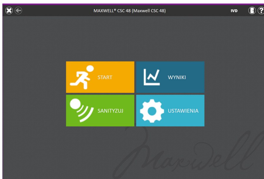
Rysunek 32. Ekran główny oprogramowania Maxwell® CSC 48. Naciśnięcie przycisku Start spowoduje uruchomienie przebiegu metody ekstrakcji w aparacie Maxwell® CSC 48 Instrument.
