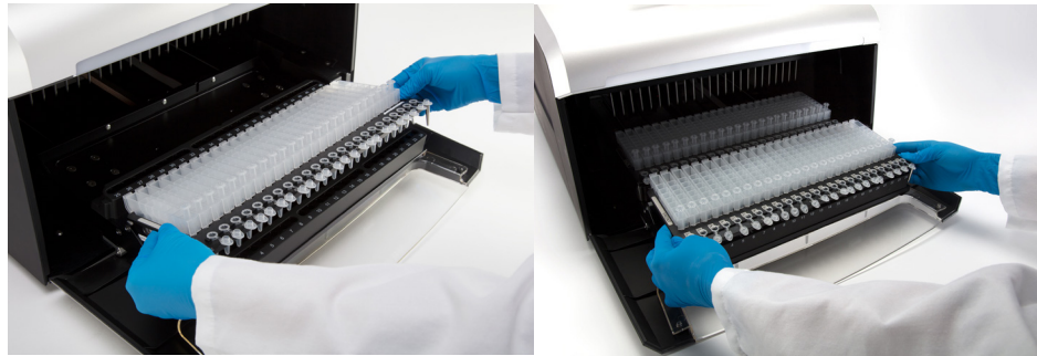
Rysunek 42. Umieszczanie tacy blatowej wewnątrz aparatu.
