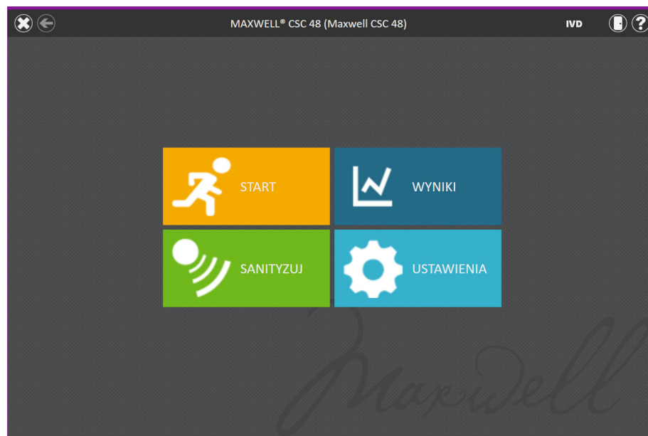
Rysunek 20. Ekran główny oprogramowania Maxwell® CSC 48. Naciśnięcie przycisku Ustawienia powoduje przejście do ekranu „Ustawienia” oprogramowania Maxwell® CSC 48.
