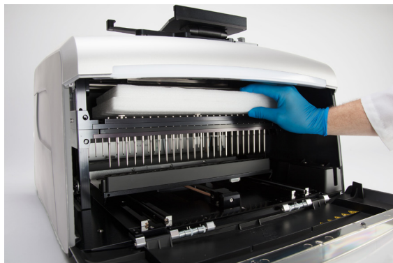
Rysunek 8. Wyjmowanie górnego piankowego bloku z wnętrza aparatu. Wsunąć pręt magnesu i pręty tłoczków, a następnie wyjąć górny piankowy blok z wnętrza aparatu.
