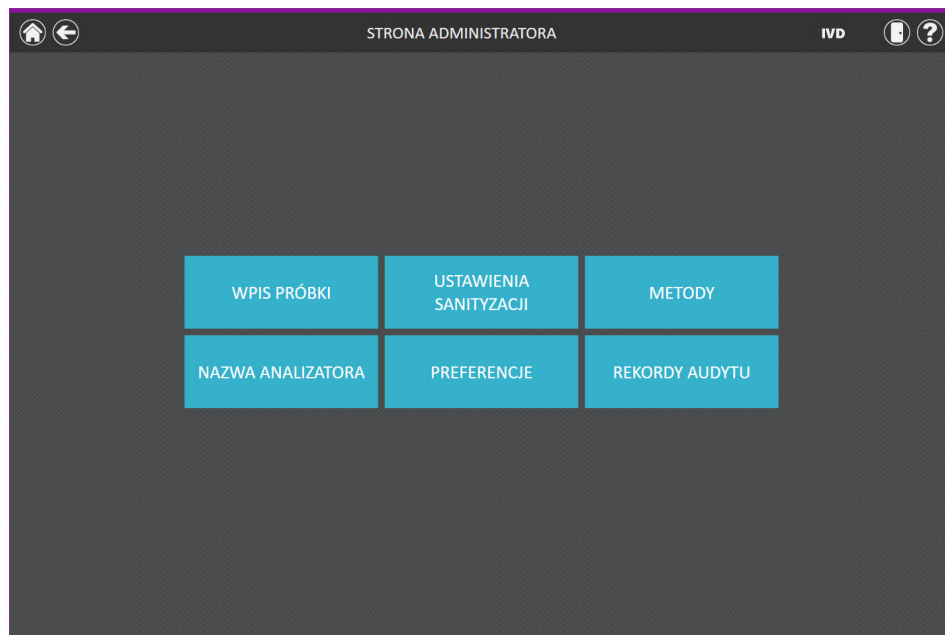
Rysunek 22. Ekran „Strona administratora” oprogramowania Maxwell® CSC 48. Ekran „Strona administratora” jest wyświetlany tylko dla administratorów i umożliwia modyfikację działania kilku funkcji systemu Maxwell® CSC 48.
