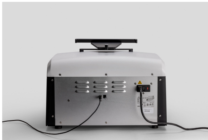
Rysunek 10. Podłączanie tabletu do gniazda w tylnej części aparatu Maxwell® CSC 48 Instrument.
