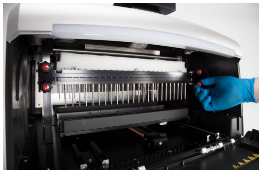
Rysunek 7. Wyjmowanie dwóch piankowych bloków z wnętrza aparatu. Panel A. Wyjąć przedni piankowy blok. Panel B. Wykręcić cztery śruby transportowe po bokach pręta przedniego magnesu i pręta tłoczków.
