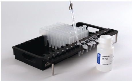
Rysunek 2. Ustawianie i konfiguracja stojaka na kartridże. Nuclease-Free Water jest dodawana do próbek do elucji w sposób przedstawiony na rysunku.
